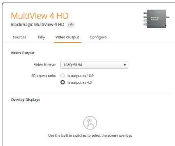
MultiView Setup Utilityの「Video Output」メニューのSDアスペクトレシオオプション
