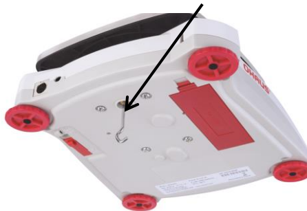
Pesata Sotto il Gancio installato
