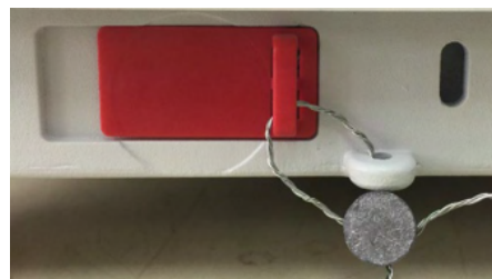
Bloccato con Sigillo di Cavo
