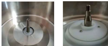
Motorwelle und -raum
